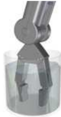
Afbeelding 23: Reinigen van de hand. Alleen de vingers mogen in water gedompeld worden.
